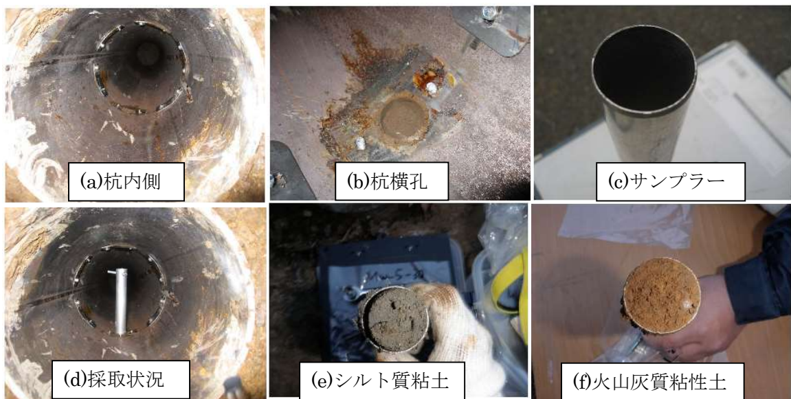
写真 4.2 杭横孔からの試料採取状況
