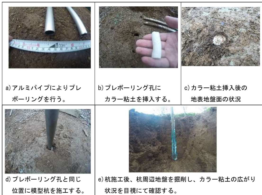
図 5.8 カラー粘土および模型杭の設置手順
