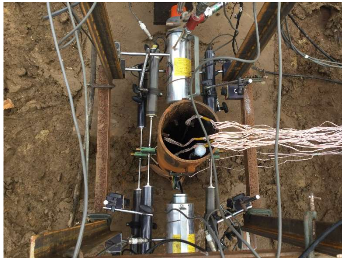
写真 6.1 加力装置設置状況
