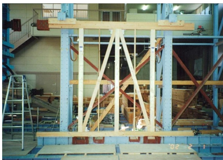
Photo3-2 筋かいの試験体
