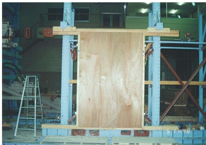
Photo3-1 構造用合板壁の試験体
