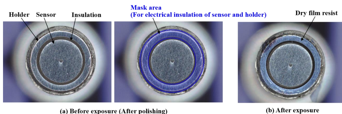
図 3-12 パターニング前後のセンサ表面観察結果
