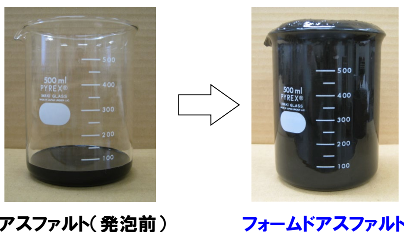
写真- 2.1 フォームドアスファルトの状態
