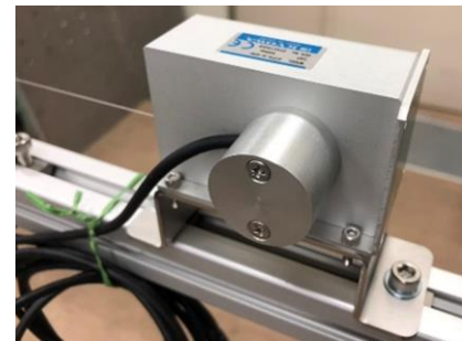
写真 6-12 ワイヤ式変位計 (DTPA-A-500)
