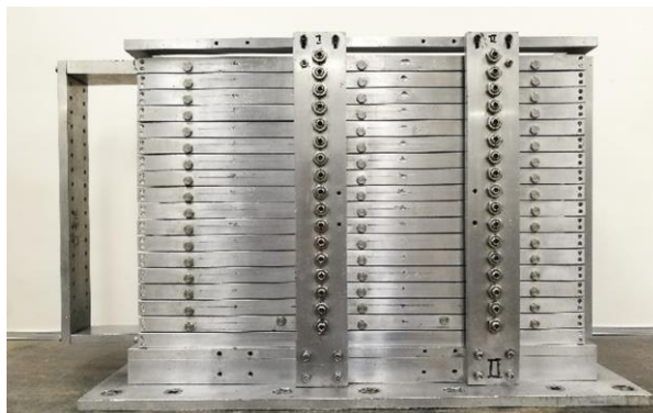
写真 6-2 セン断土槽
