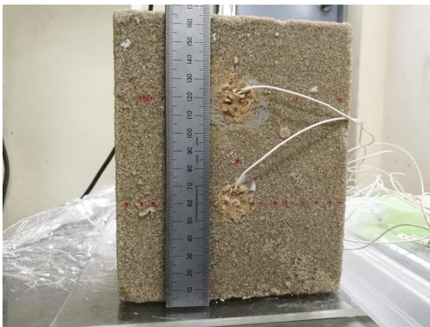
写真 6-13 改良体の出来形と加速度計の設置状況
