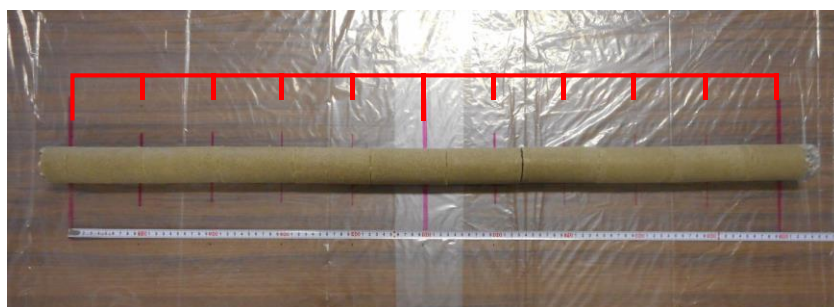
写真 4-8 脱型した供試体
