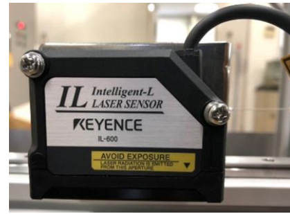
写真 6-11 レーザー式変位計 (DTPA-A-500)
