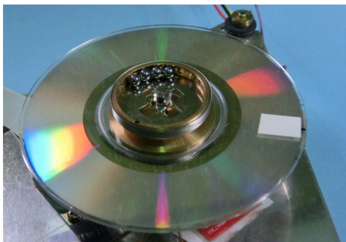
図2-8 鋼球を用いた自動平衡装置
