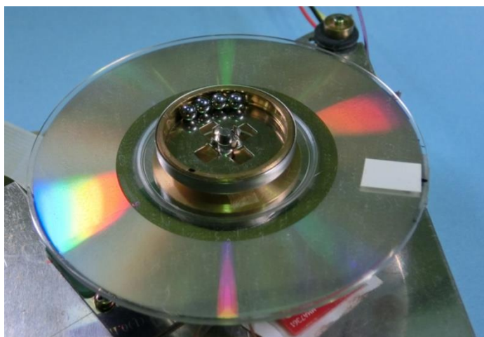
図 2-8 鋼球を用いた自動平衡装置
