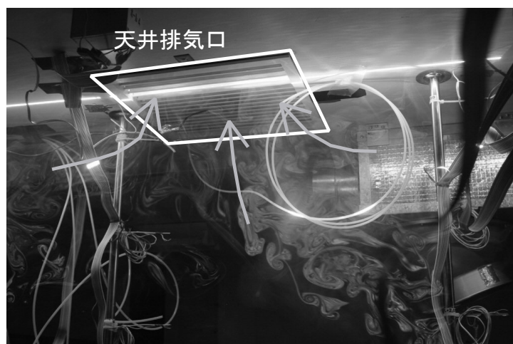
写真 3.5 天井排気口の可視化状況
