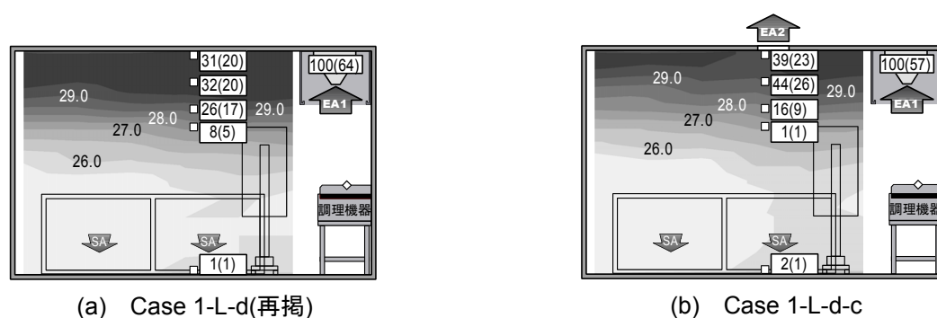
図 3.5 実験結果(天井排気口の効果)
