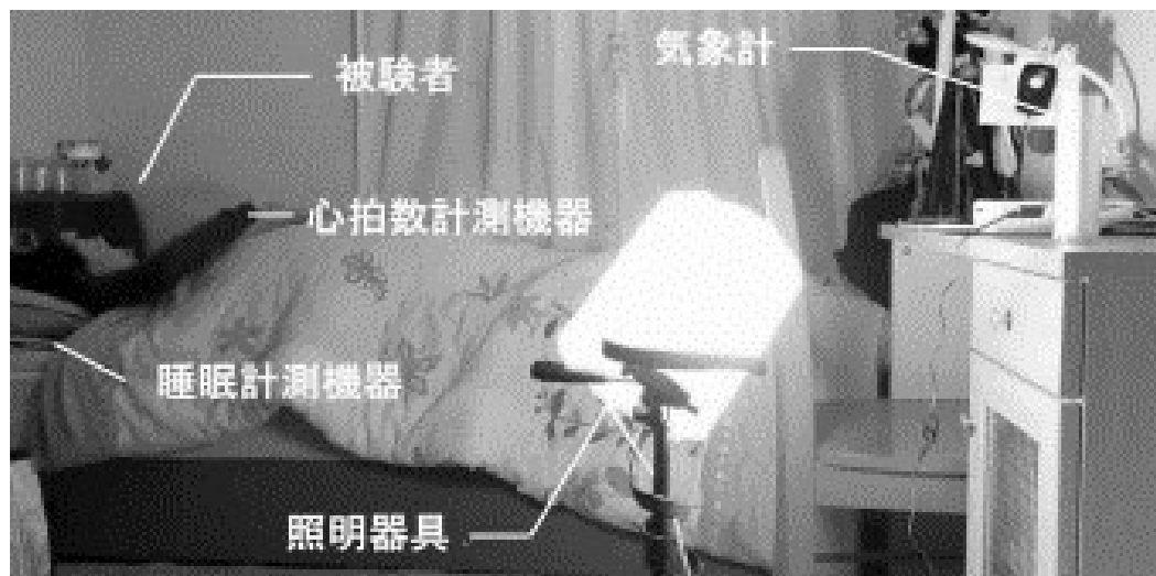
図 32 : 実験設備設置状況 b : 調光機能照明、気象計、照度計、睡眠計
