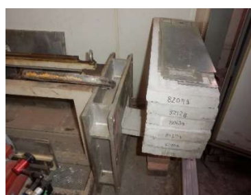
(b) 終盤の载荷状況(板重量 1\text{kg} )
