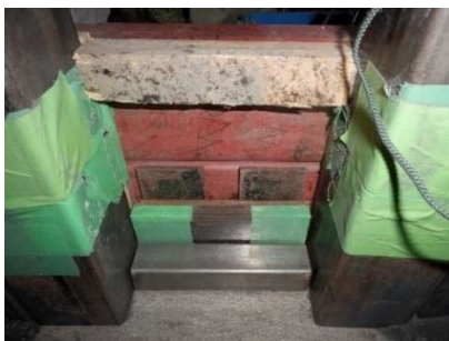
写真-6.1 角パイプの設置
