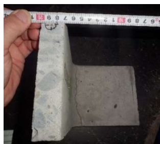
写真-5.2 配筋の有効高さ (供試体 d, 15mm)
