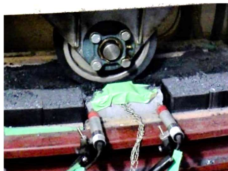
(b) 破壊直後のたて壁
