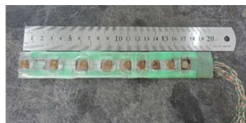
写真-2.5 配線の固定
