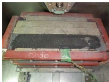
写真-2.12 載荷後の表面(1472N, 深さ3cm)
