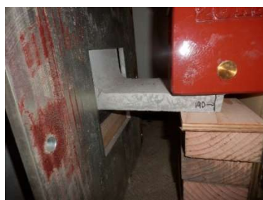
(a) 载荷位置(取付部より 185\sim 190\text{mm} )
