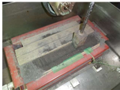
写真-2.13 タンパ転圧
