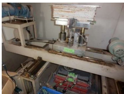
写真-6.5 ホイールトラッキング試験機(載荷装置)
