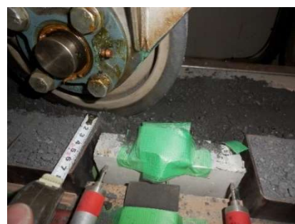
(b) 破壊直後のたて壁
