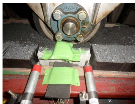
(b) 破壊直後のたて壁
