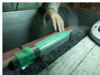
写真-2.7 圧力計の養生
