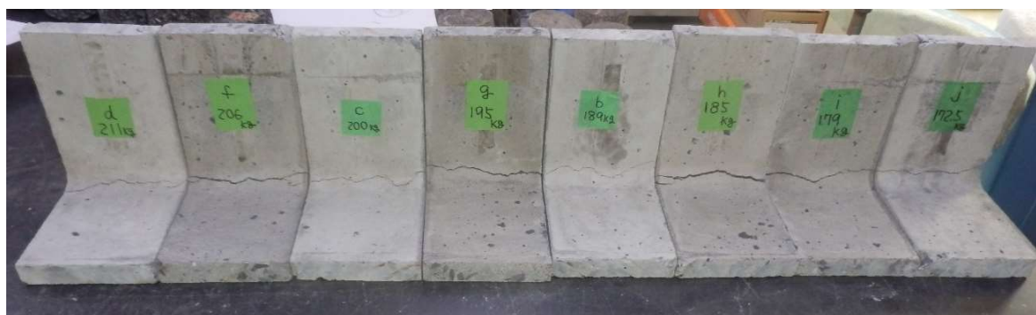
写真-6.10 疑似L型擁壁の背面に発生したひびわれ(左側から 2073N, 2019N, 1967N, 1911N, 1855N, 1809N, 1757N, 1692N)
