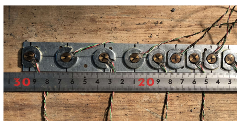
写真-2.4 圧力計の固定
