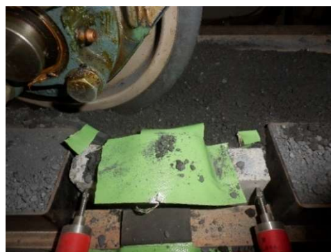
(b) 破壊直後のたて壁
