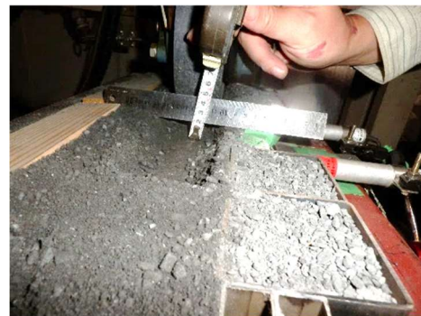
(b) たて壁破壊直後の試験輪の沈み込み
