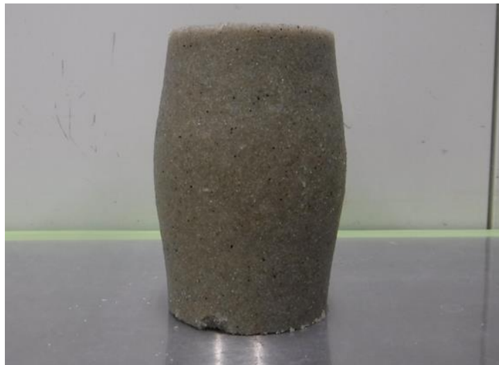
写真-3.7 \overline{CU} 試験における破壊形状 (珪砂 5 号, D_r=60\% , C_s=6\% )
