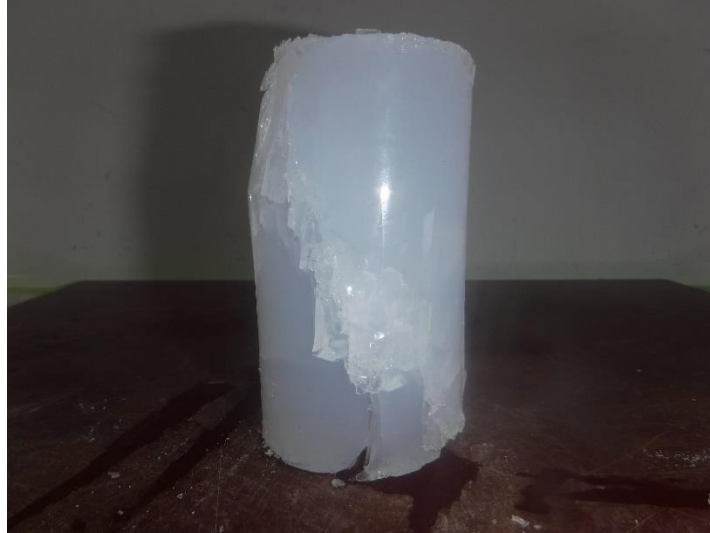
写真-2.8 ヒドロゲルの UU 試験における破壊形状
