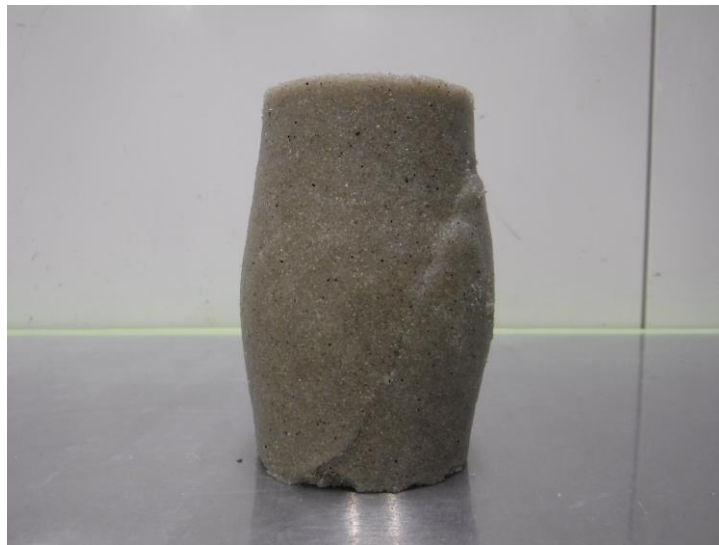
写真-3.8 CD 試験における破壊形状（珪砂 5 号, D_r=60\% , C_s=6\% ）
