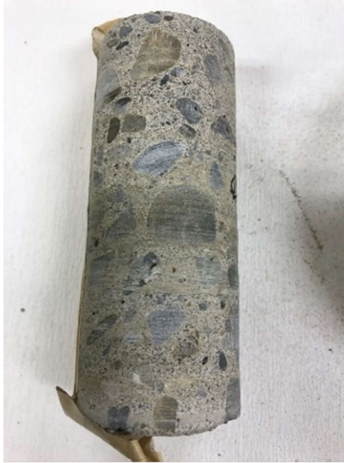
図Ⅲ-5 コンクリート供試体（東京都市大学の原子力研究所のコアボーリング試料）
