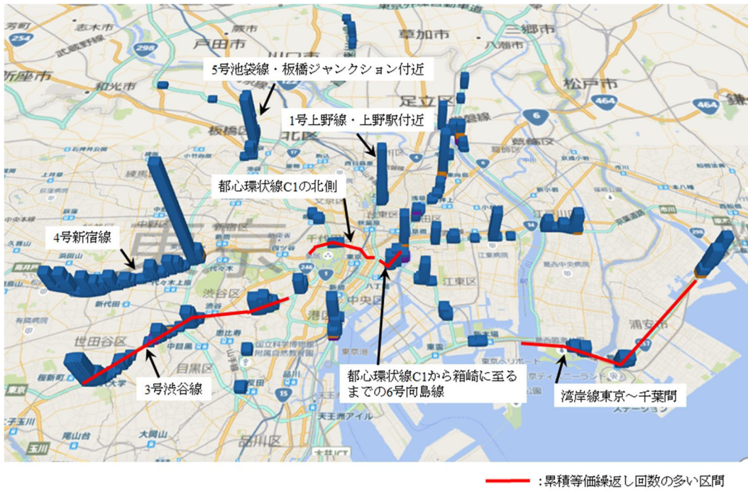
図 3-10 累積等価繰返し回数の多い箇所と疲労き裂発生箇所との関係
