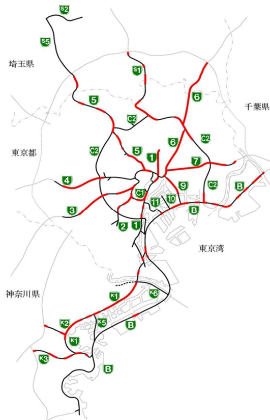
図 3-11 鋼 I 桁橋が用いられている区間
