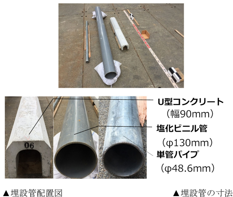
図 3-25 埋設管の配置図および寸法
