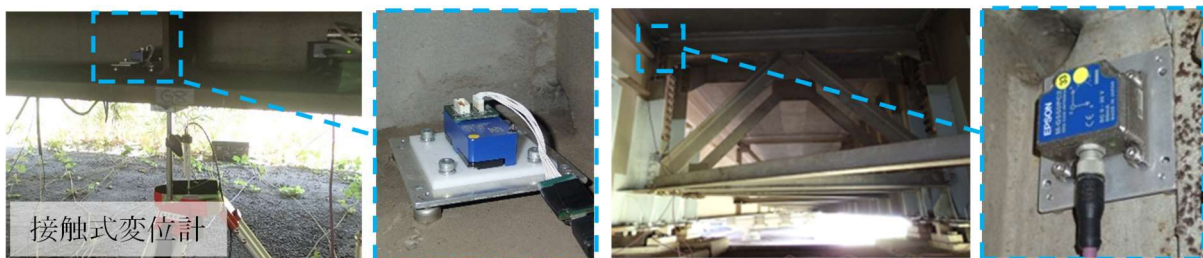
図 3-3 センサの設置状況 3-3)
