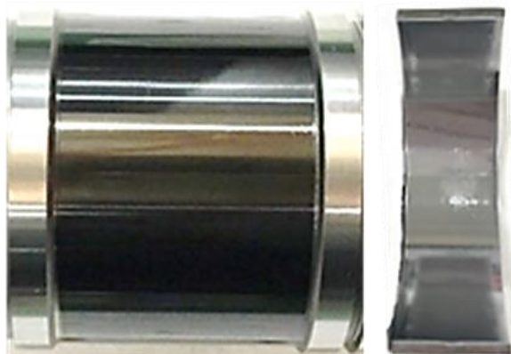
図 4-6 試験後の DLC ジャーナルと軸受
