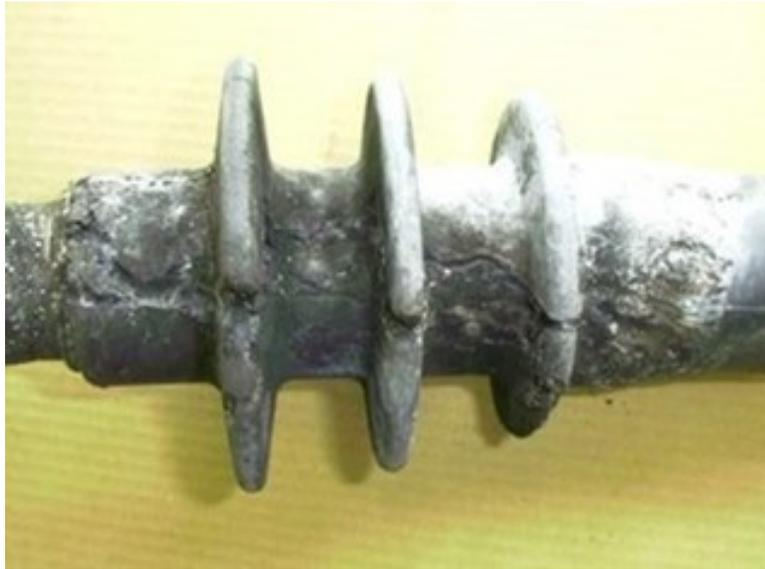
図 1.23 終端接続部のトラッキングによる焼損事故例<sup>(18)</sup>
