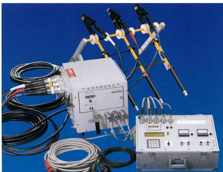
図 1.24 低周波重畳法導入当初の CV ケーブル活線劣化診断装置 (CMLF 3号機)
