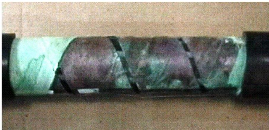
図 1.18 開き（ギャップ）巻きで腐食している遮へい銅テープ<sup>(12)</sup>
