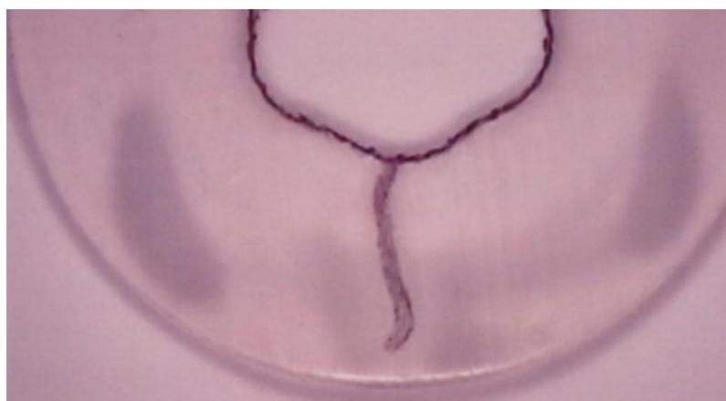
図 4.15 白濁リングにより 21kV で絶縁破壊を起こした絶縁体<sup>(1)</sup>
