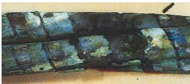
図 1.20 遮へい銅テープの破断による絶縁破壊事故例<sup>(16)</sup>
