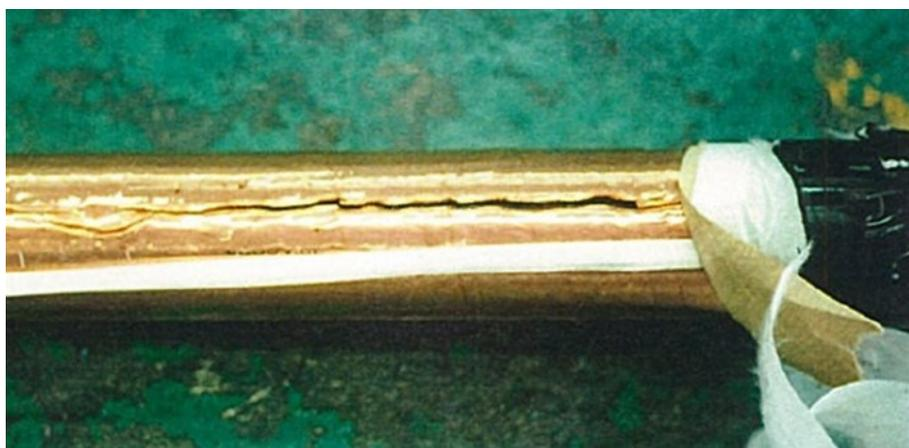
図 1.16 膨張・収縮による長手方向の破断が生じた遮へい銅テープ <sup>(13)</sup>
