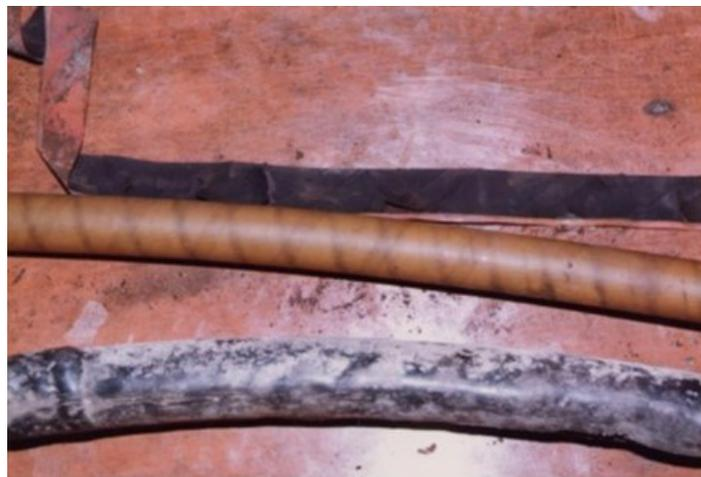
図 4.12 熱劣化と遮へい銅テープの腐食が確認された No.11 のケーブルの解体状況<sup>(1)</sup>
