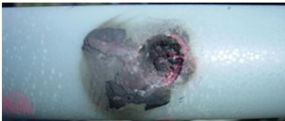
図 1.14 水トリ劣化による絶縁破壊例<sup>(21)</sup>
