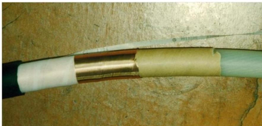
図 1.9 半導電層が施されていない 3.3kV の CV ケーブル
